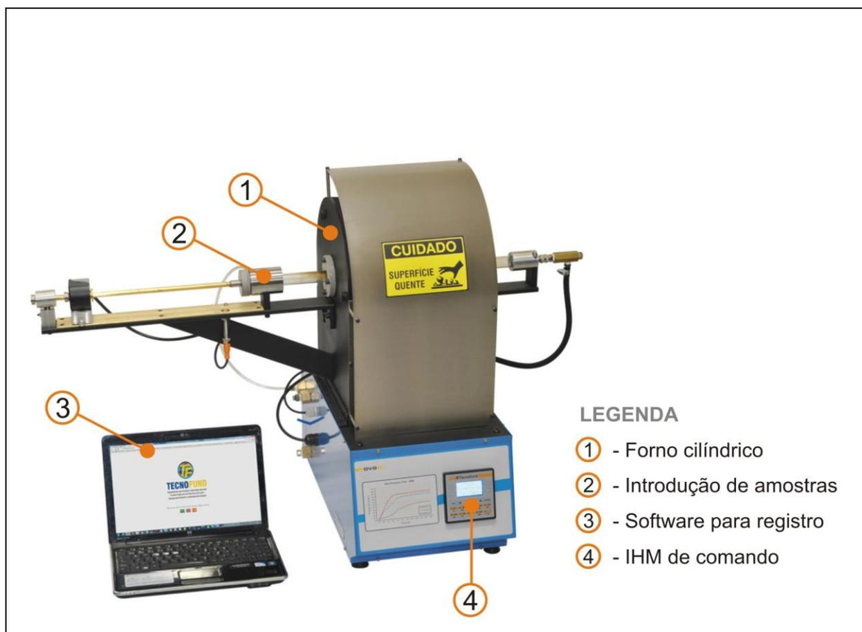
Figura 1 – Foto ilustrativa do aparelho medidor de pressão de gases.
